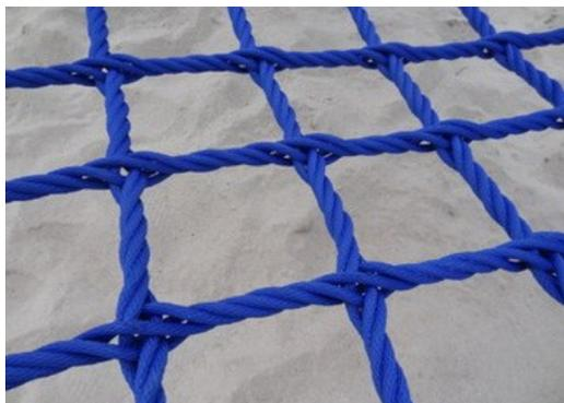
Las redes para las hamacas están fabricadas con cuerdas Corocord de 16 mm. La conexión entre las cuerdas se empalma manualmente para evitar objetos duros en el área. El tamaño de la malla no permite pasar a través de la red.
