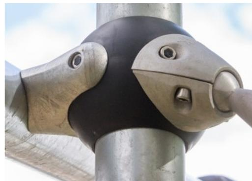
Le design unique de la sphère de liaison GALAXY est fabriqué à partir d'une base intérieure circulaire en aluminium, enrobée d'une coquille de PP dure, et d'une couche extérieure de caoutchouc TPV souple. Des raccords flexibles en aluminium sans plomb permettent une installation à angle variable.
