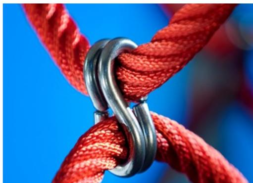
I morsetti a "S" di Corocord sono utilizzati come connessioni universali nei prodotti Corocord. Le aste in acciaio inossidabile da 8 mm con bordi arrotondati sono pressate attorno alle corde con una speciale pressa idraulica, rendendole il connettore ideale: sicuro, durevole e antivandalismo, il tutto pur consentendo il tipico movimento delle strutture di gioco della corda.
