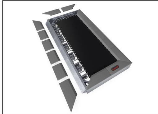
Als einzigartiges Merkmal können die SBR-Platten zur Reinigung und Wartung entfernt werden. Durch Lösen von sechs Schrauben kann die SBR-Platte angehoben werden, um sie zu öffnen und Zugang zu den Federn zu erhalten (siehe Anleitung auf KOMPAN Master).
