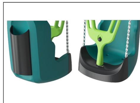
Le siège de balançoire inclusif est réalisé en polyéthylène (PE) recyclable, fabriqué avec 33 % de matériaux post-consommation. Il est moulé en une seule pièce et équipé d'un trou d'évacuation pour éviter l'accumulation d'eau. Conçu de manière ergonomique, il garantit une assise sécurisée et confortable.
