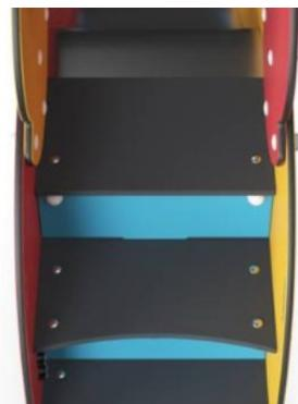
Los steps están hechos de HPL laminado de alta presión con un espesor de 17,8 mm y textura de superficie antideslizante según EN 438-6. KOMPAN HPL tiene una alta resistencia al desgaste para garantizar una larga vida útil en todos los climas.
