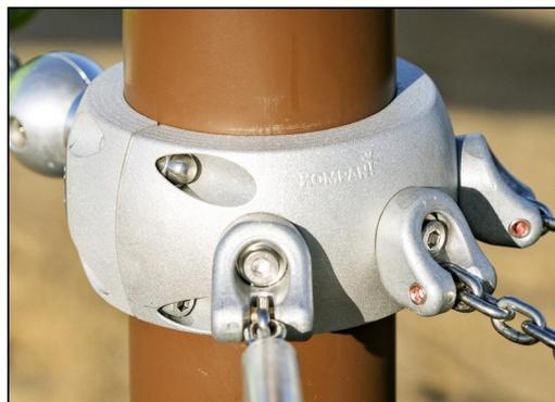
Les pinces intelligentes Corocord sont soigneusement conçues dans les moindres détails pour assurer une flexibilité supérieure dans un matériau en aluminium de haute qualité. Les pinces intelligentes sont fixées autour des poteaux avec quatre boulons en acier. Les points d'attache non utilisés sont fermés par des capuchons en polyamide (PA).
