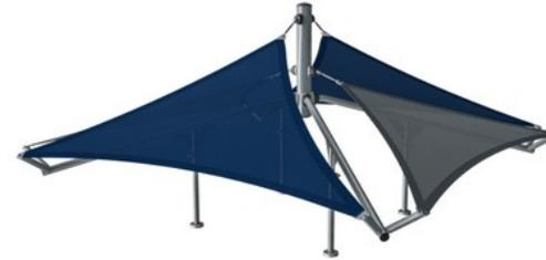
Sonnensegel aus PE-HD, das speziell zum Sonnenschutz entworfen wurde. Die Segel wurden mit UV-Stabilisatoren behandelt, um für eine lange Lebensdauer zu sorgen. Zudem sind die Segel mit einem feuerverzinkten Stahlrahmen versehen und werden durch Edelstahlelemente gesichert.
