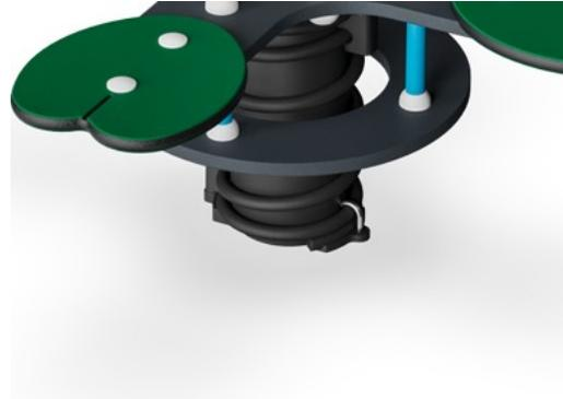
KOMPAN Federn bestehen aus hochwertigem Federstahl nach EN 10270-1. Die Federn werden durch Phosphatierung gereinigt, bevor sie mit einer Epoxid-Grundierung und Polyester-Beschichtung überzogen werden. Die Federn werden mit speziellen Klemmschutz-Elementen angebracht, um für höchste Sicherheit und eine hohe Lebensdauer zu sorgen.
