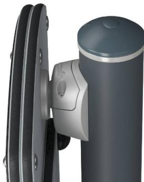
Los conectores están fabricados en aluminio fundido a presión especialmente aleado para entornos exteriores y con un contenido de plomo inferior a 100 ppm. Los conectores se fijan a los postes mediante tornillos de acero inoxidable y están bien protegidos contra la corrosión mediante arandelas de zinc de diseño especial. Son extremadamente resistentes y no presentan ningún riesgo de corrosión.
