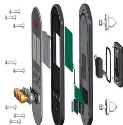
Los paneles frontales son de policarbonato estabilizado a los rayos UV. La estabilización a los rayos UV evita que los paneles transparentes se pongan amarillos con el tiempo y garantiza las prestaciones mecánicas. Las impresiones gráficas se añaden mediante un proceso único de impresión multicapa en el que la capa interior es la imagen y la capa exterior transparente funciona como protección. La laca es de base acuosa y está estabilizada a los rayos UV para evitar la decoloración.
