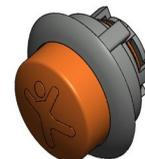
Los pulsadores y la carcasa de los mismos están fabricados en poliamida (PA6). Los pulsadores contienen un imán que activa un interruptor de láminas sin contacto cuando se pulsan los botones. Esto garantiza una gran durabilidad del sistema.
