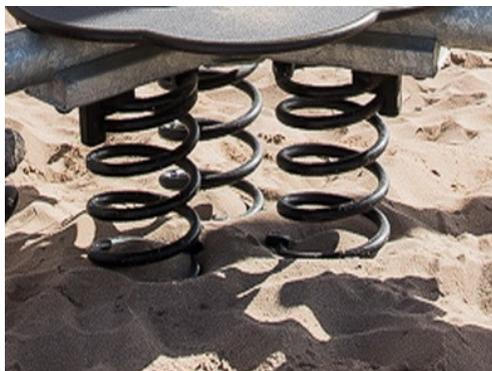
Les ressorts KOMPAN sont fabriqués en acier de haute qualité selon la norme EN 10270. Les ressorts sont nettoyés par phosphatation, avant d'être peints avec une amorce époxy et un revêtement thermolaqué de polyester en guise de finition. Les ressorts sont fixés par des raccords anti-pincement uniques pour une sécurité maximale et une longue durée de vie.
