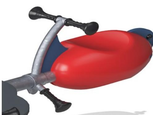
Les poignées et les repose-pieds sont fabriqués avec un insert polypropylène (PP) moulé et une couche extérieure de caoutchouc TPV souple. Les poignées et les repose-pieds sont fixés au tuyau avec un renfort interne en acier galvanisé afin d'assurer à la fois résistance et durabilité.
