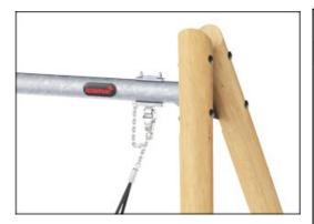
Ganci oscillanti KOMPAN progettati per impieghi con pesi in acciaio inossidabile con funzione anti-torsione. I ganci sono fissati alla traversa su una staffa saldata con due bulloni, i cuscinetti sono incorporati con lubrificante siliconico e non necessitano di ulteriore lubrificazione.
