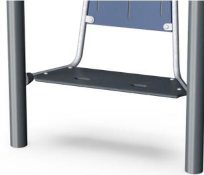
Die Stufen sind aus HPL (Hochdrucklaminat) mit einer Dicke von 17,8 mm und rutschfester Oberflächenstruktur gemäß EN 438-6 gefertigt. KOMPAN HPL hat eine hohe Verschleißfestigkeit, um eine lange Lebensdauer in allen Klimazonen zu gewährleisten.
