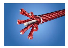
Le corde Corocord con diametro di 19 mm o più sono speciali "tipo Hercules" con fili di acciaio zincato a sei fili. Ogni filo è strettamente avvolto con filato PES, che viene fuso su ogni filo individuale. Le corde sono altamente resistenti all'usura e agli atti vandalici e possono essere
