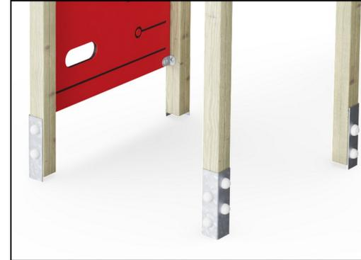
Die Pfosten der Haupttürme sind mit feuerverzinkten Stahlfüßen erhältlich. Die Stahlfüße heben die Pfosten 20 mm von der Grundfläche an, sodass Kontakt mit dem Oberflächenmaterial verhindert wird.
