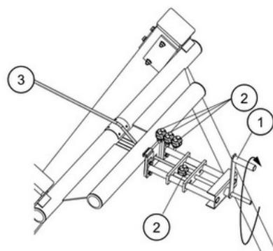
Das Stahlseil 3 wird mit einer speziell entwickelten Vorrichtung gespannt. Indem der Hebel 1 umgelegt wird, kann das Stahlseil nach Anleitung und auf sichere Weise gespannt werden. Nach dem Spannen wird das Seil mit 3 Klammern 2 festgestellt. Die Spannvorrichtung kann auch für Anpassungen während der jährlichen Inspektion genutzt werden.
