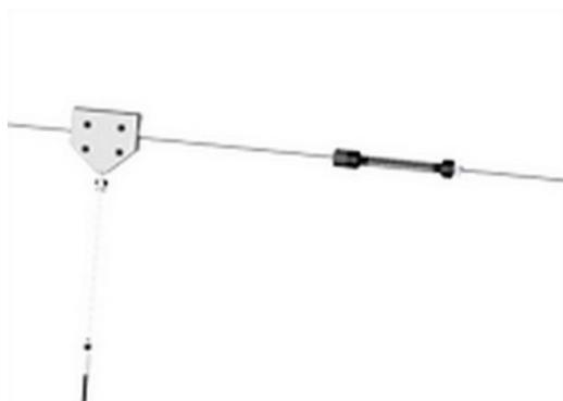
Das hochwertige Stahlseil mit einem Durchmesser von 12 mm wurde für eine dauerhafte starke Benutzung der Seilbahn konzipiert. Der Ausgangspunkt ist durch einen Knopf gekennzeichnet. Am Haltepunkt befindet sich eine speziell entwickelte Federvorrichtung, welche ein sanfteres Stoppen der Zugvorrichtung gewährleistet.
