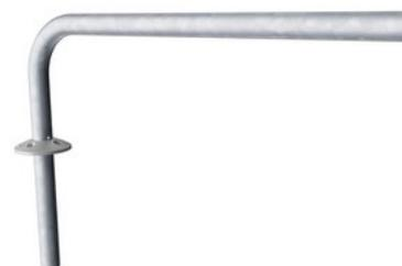
Les balustrades qui servent de poignées pendant les exercices sont faites d'acier galvanisé par immersion à chaud de 38 mm, un diamètre idéal pour une bonne prise en main et pour soutenir les poignets. Leur hauteur est de 940 mm à partir du haut de la plaque HPL. La distance entre les balustrades est de 900 mm.
