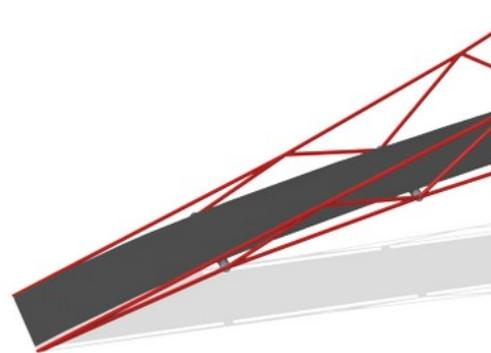
Die Corocord Membranen bestehen aus rutschfestem, gummiertem Material in Förderband-Qualität, das eine exzellente UV-Beständigkeit aufweist. Die geprüfte Konformität mit den REACH-Anforderungen für PAK ist gegeben. In die Membranen ist eine vierlagige Armierung aus gewebtem Polyester eingebettet. Die Armierung und die doppelte Oberflächenschicht ergeben eine Gesamtstärke von 7,5 mm.
