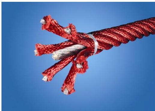
直径大于等于 19mm 的 Corocord 绳索是特殊的“大力神”型镀锌六股钢丝。每根丝束都用 PES 纱紧密包裹，然后将其熔化到每根独立的丝束上。这些绳索具有很高的耐磨性和防破坏性，可以根据需要在现场更换。
