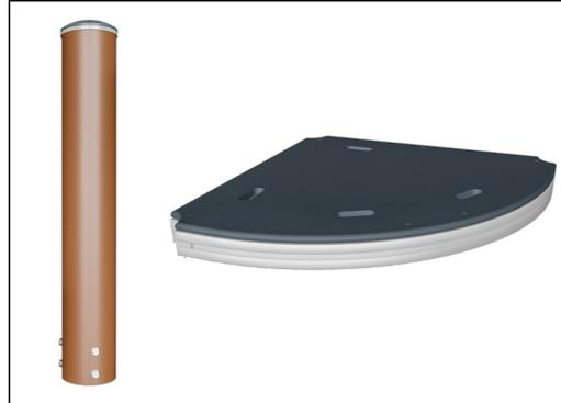
Die ELEMENTS™ Plattformen bestehen aus 17,8 mm starkem HPL-Boden. Die Plattformen werden durch einen speziell entwickelten Aluminium-Rahmen gestützt und können mit Aluminium-Verbindungen vielseitig angebracht werden. Die Hauptpfosten werden aus vorverzinktem Stahl hergestellt und sind pulverbeschichtet. Die Spitze der Pfosten ist mit Kunststoff-Kappen geschlossen, die aus UV-beständigem Nylon (PA6) bestehen.
