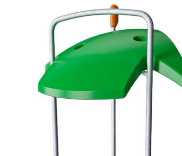
Střechy řady ELEMENTS jsou vyrobeny z recyklovatelného PE z 33 % tvořeného post-spotřebními materiály s minimální tloušťkou stěny 5 mm, aby byla zajištěna vysoká životnost ve všech klimatických podmírkách po celém světě. Ocelové trubky jsou žárově zinkované uvnitř i vně, aby byla zajištěna maximální životnost.
