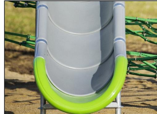
Geformte PE-Rutschen aus 33% Post-Consumer-Materialien in verschiedenen Farben in einem Stück mit einer Wandstärke von mindestens 5 mm. Das PE ist auf UV-Beständigkeit getestet und hat eine ausgezeichnete Schlagzähigkeit und ist innerhalb einer großen Temperaturspanne verwendbar.
