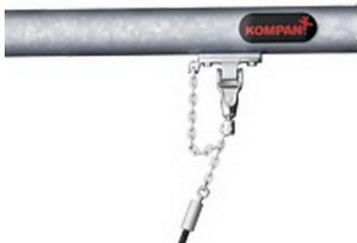
Crochets de suspension KOMPAN robustes en acier inoxydable avec fonction anti-torsion. Les cintres sont fixés à la traverse sur un support soudé avec deux boulons, les roulements sont intégrés avec du lubrifiant silicone et ne nécessitent aucune lubrification supplémentaire.
