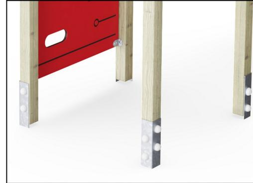
Les poteaux principaux sont équipés de pieds en acier galvanisé à chaud. Les pieds en acier surélèvent les poteaux de 20 mm du niveau du sol pour éviter tout contact avec le revêtement de surface.
