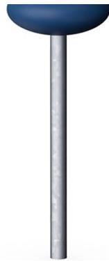
Das Rohr des Grasshüpfers besteht aus einem feuerverzinktem Stahlrohr mit einem Durchmesser von 48,3 x 2,9 mm. Der obere Sitz ist mit einer M12-Schraube verbunden und mit einer PE-Abdeckkappe abgedeckt.
