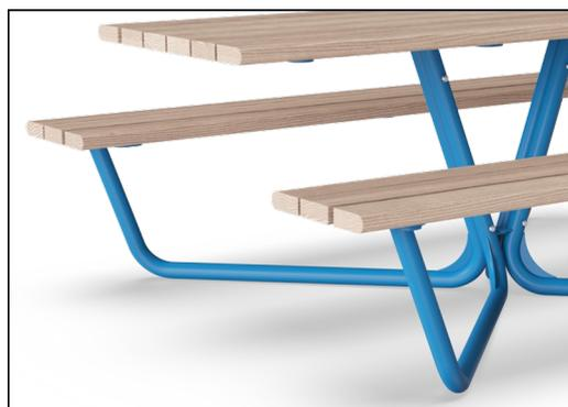
La finition supérieure thermolaquée appliquée sur la galvanisation est traitée en deux étapes : Meulage léger et nettoyage, puis revêtement thermolaqué – épaisseur 70-120 µm.
