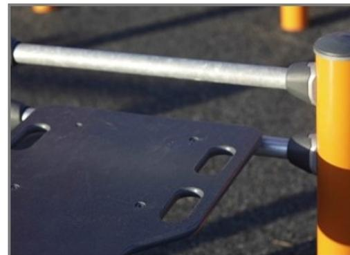
Le revêtement de surface est constitué de panneaux Ekogrip®, faits de polyéthylène de 15 mm et recouverts de 3 mm de caoutchouc thermoplastique. Les panneaux Ekogrip® sont antidérapants pour un entraînement confortable en toute sécurité, quelles que soient les conditions extérieures.
