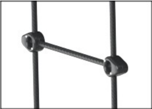
Seile aus UV-stabilisierten PES-Seilsträngen mit innerer Stahlseilverstärkung. Das Polyestergarn besteht aus +95% Post-Consumer-Materialien und wird induktiv auf jede Litze aufgeschmolzen, um eine hervorragende Verschleißfestigkeit zu erreichen.
