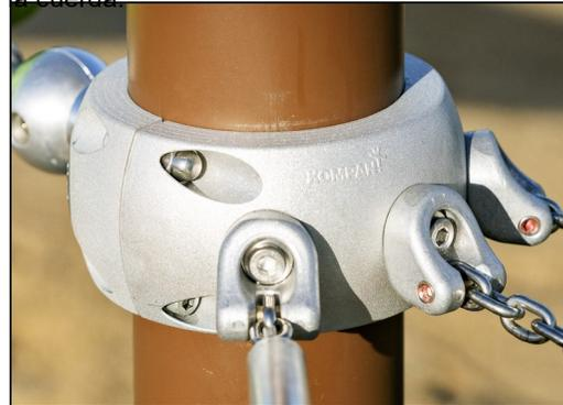
Las abrazaderas inteligentes Corocord están cuidadosamente diseñadas en cada detalle para garantizar una flexibilidad superior en material de aluminio de alta calidad. Las abrazaderas inteligentes se fijan alrededor de los postes con cuatro pernos de acero. Los puntos de fijación no utilizados se cierran con tapones de PA.
