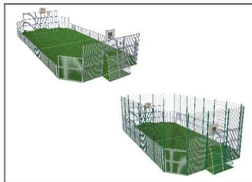
La hauteur du poteau au-dessus du sol peut varier de 1, 2, 3 ou 5 m. Dans la version à cheviller, les platines font 200 mm x 200 mm x 10 m. Dans la solution à enterrer, les poteaux seront enterrés de 45 cm pour les panneaux latéraux et de 90 cm pour les panneaux de but.
