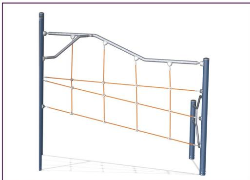
Les cordes ELEMENTS sont munies de toron d'acier à six brins et d'un cœur en câble d'acier. Chaque toron est enveloppé hermétiquement dans du fil en PES. Une fois que le frottement initial a enlevé les fibres de surface, un revêtement plus dur de PES reste pour protéger chaque brin, garantissant une excellente résistance à l'usure et au vandalisme.
