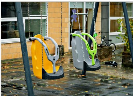
Il seggiolino inclusivo per altalena è realizzato in polietilene (PE) riciclabile, utilizzando il 33% di materiali post-consumo. Il sedile è stampato in un unico pezzo e dotato di un foro di scarico per evitare l'accumulo di acqua. Il design ergonomico consente una posizione di seduta sicura e confortevole.
