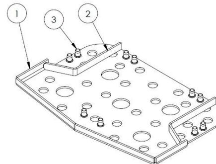
Une plaque d'acier en carbone galvanisée de 5 mm est moulée à l'intérieur du SBR afin d'offrir une stabilité optimale et d'optimiser le montage des marches sur le cadre.
