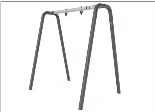
Vertikale Pfosten aus feuerverzinktem Stahl oder pulverbeschichtet auf vorverzinktem Stahlfuß. Schwenkrahmen-Endverbinder und Querträger aus feuerverzinktem Stahl oder pulverbeschichtet auf feuerverzinktem Stahlfuß.
