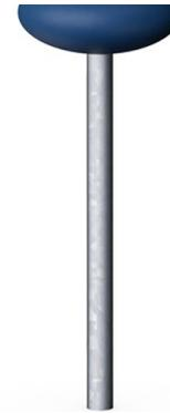
Das Rohr des Grasshüpfers besteht aus einem feuerverzinktem Stahlrohr mit einem Durchmesser von 48,3 x 2,9 mm. Der obere Sitz ist mit einer M12-Schraube verbunden und mit einer PE-Abdeckkappe abgedeckt.
