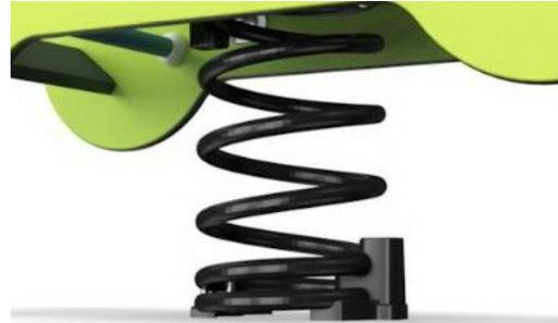
KOMPAN Federn bestehen aus hochwertigem Federstahl nach EN 10270-1. Die Federn werden durch Phosphatierung gereinigt, bevor sie mit einer Epoxid-Grundierung und Polyester-Beschichtung überzogen werden. Die Federn werden mit speziellen Klemmschutz-Elementen angebracht, um für höchste Sicherheit und eine hohe Lebensdauer zu sorgen.
