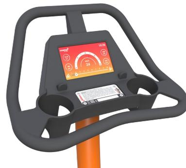
Le guidon est conçu avec plusieurs positions des mains permettant différentes postures et styles de conduite. Il s'agit d'une pièce en aluminium moulé avec revêtement Polyurea pour une bonne prise en main et isolation.
