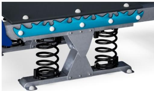
Los muelles KOMPAN están hechos de acero de resorte de alta calidad según EN10270. Los muelles se limpian mediante fosfatación antes de pintarlos con una imprimación epoxi y un recubrimiento de poliéster en polvo como acabado superior. Los muelles se fijan mediante accesorios anti-pelliczos únicos para máxima seguridad y larga vida útil.
