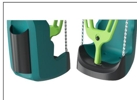
L'amortisseur avant est composé d'un noyau en polypropylène (PP) résistant avec une couche extérieure plus souple en caoutchouc thermoplastique (TPE), tandis que l'amortisseur arrière est doté d'une membrane en caoutchouc EPDM de 8 mm d'épaisseur. Les amortisseurs souples absorbent les chocs, sont dotés d'une surface antidérapante et permettent ainsi une utilisation sécurisée du siège de balançoire par les surveillants.
