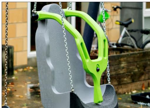
Le harnais est réalisé en polyéthylène (PE) recyclable moulé, fabriqué avec 33 % de matériaux post-consommation. Le harnais utilise un ressort de torsion en acier inoxydable qui lui permet de rester dans toutes les positions pour faciliter la montée et la descente des utilisateurs. Le verrou du harnais est conçu avec une pièce coulissante en acier inoxydable qui s'opère d'une seule main.
