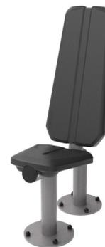
El asiento y el respaldo están hechos de Caucho de Poliuretano (PUR) y tienen una placa de inserción de acero electrogalvanizado que conecta el asiento con el marco. El asiento se coloca en un ángulo de 9 grados y el respaldo tiene un ángulo de 15 grados. El respaldo tiene una ranura para aliviar la columna vertebral, lo que permite una posición cómoda para sentarse.
