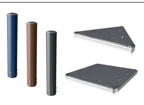
Hlavní sloupy jsou vyrobeny z vysoko kvalitní pozinkované oceli s povrchovou úpravou práškovým lakem. Vrcholy sloupků jsou uzavřeny krytkami z UV stabilizovaného nylonu (PA6). Tvarované šedé desky jsou vyrobeny ze 75 % postkonzumního odpadu PP materiálu s protiskluzovým vzorem a strukturováným povrchem. Všechny desky jsou podepřeny unikátně navrženými nízkouhlíkovými břidlicovými lištami s několika možnostmi uchycení.
