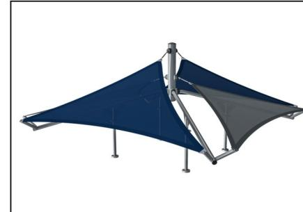
Plachty z komerčního vysokohustotního 95 PE, pléténé speciálně pro struktury chránící před sluncem. Plachty jsou ošetřeny UV stabilizátory pro zajištění dlouhé životnosti. Plachty jsou podepřeny žárově zinkovaným ocelovým rámem a napnuté nerezovými součástkami.
