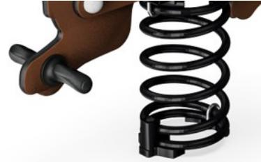
Les ressorts KOMPANI sont fabriqués en acier de haute qualité selon la norme EN 10270. Les ressorts sont nettoyés par phosphatation, avant d'être peints avec une amorce époxy et un revêtement thermolaqué de polyester en guise de finition. Les ressorts sont fixés par des raccords anti-pincement uniques pour une sécurité maximale et une longue durée de vie.
