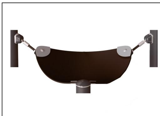
Le membrane Corocord sono realizzate in materiale gommato antifrizione della qualità del nastro trasportatore con eccellente resistenza ai raggi UV. Testato e conforme ai requisiti REACH per PAH. Embedded è un rivestimento a quattro strati realizzato in poliestere intrecciato. L'armatura e i due strati superficiali producono uno spessore totale di 7,5 mm.
