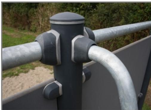
Los conectores están hechos de aluminio fundido a presión, especialmente aleados para ambientes exteriores y uso intensivo. Los tornillos que sujetan los conectores son de acero inoxidable y están protegidos por arandelas de zinc.
