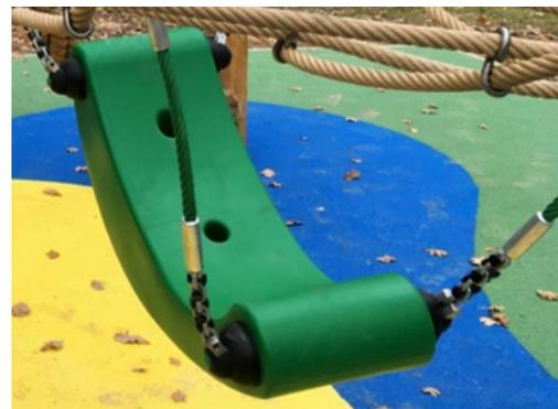
Die großen Kunststoffteile bestehen aus 100 % recyclebarem Kunststoff (PE) aus 33 % Post-Consumer-Material. Der Schalensitz ist in einem Stück formgepresst und aus mindestens 5 mm dicken Wänden gefertigt. Das Material ist besonders langlebig in allen Klimazonen.
