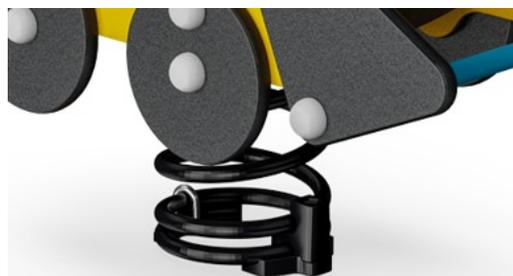
Los muelles KOMPAN están hechos de acero de resorte de alta calidad según EN10270. Los muelles se limpian mediante fosfatación antes de pintarlos con una imprimación epoxi y un recubrimiento de poliéster en polvo como acabado superior. Los muelles se fijan mediante accesorios anti-pelliczos únicos para máxima seguridad y larga vida útil.
