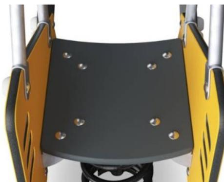
El asiento está hecho de panel Ekogrip® que consiste en una base de PE de 15 mm de espesor con una capa superior de goma blanda de 3 mm con un efecto antideslizante.
