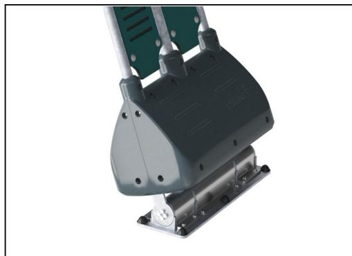
Il movimento oscillante avanti e indietro è controllato da un elemento a molla di torsione in doppia gomma graduata per impieghi gravosi. L'elemento in gomma garantisce un movimento sicuro e riduce la velocità verso le piattaforme della torre. La copertura della base è in PE stampato ad alta resistenza agli urti.
