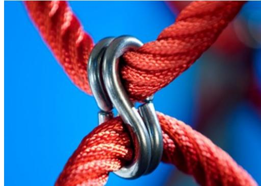
„S“ svorky Corocord se u produktů Corocord používají jako univerzální spojovací prvek. 8mm nerezové dráty se zaoblenými konci jsou za pomoci speciálního hydraulického nástroje nalisovány kolem lana, což z nich dělá ideální konektor: bezpečný a odolný proti vandalismu s dlouhou životností, to vše s umožněním typického pohybu lanových herních struktur.
