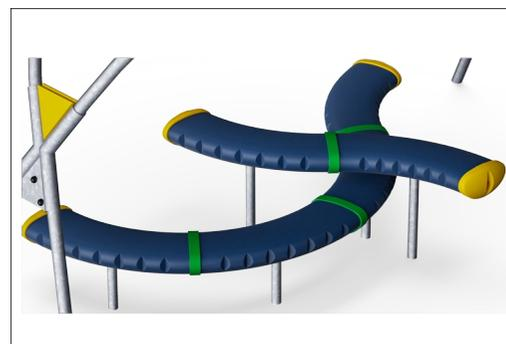
Los grandes componentes son de PE 100% reciclable fabricado con un 33% de materiales postconsumo. Moldeado en una sola pieza con un grosor de pared mínimo de 5 mm para garantizar una gran durabilidad en todos los climas del mundo.
