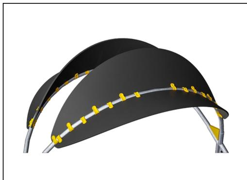
El techo está hecho de un panel Ekogrip® con estructura de acero. El panel Ekogrip® consta de una base de PE de 15 mm de espesor con una capa superior de goma de 3 mm.
