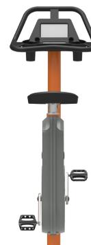
Il fattore Q della bici da braccio è di 175 mm, la pedivella è in acciaio inossidabile da 18 mm e collega i bracci del pedale che sono parti in acciaio inossidabile fuso (grado 304). La lunghezza dei bracci del pedale è di 170 mm e i pedali sono collegati con raccordi standard per bici.
